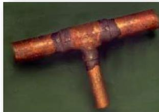
**Leghe per la brasatura** (processo di unione di materiali metallici, realizzato per fusione del solo metallo d'apporto detto lega il cui punto di fusione è più basso di quello del metallo base)
